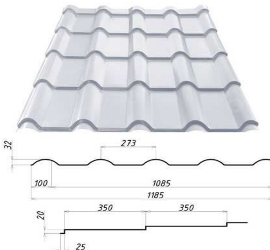
Рисунок 3 – Внешний вид и размеры листа металлочерепицы «Афина»
