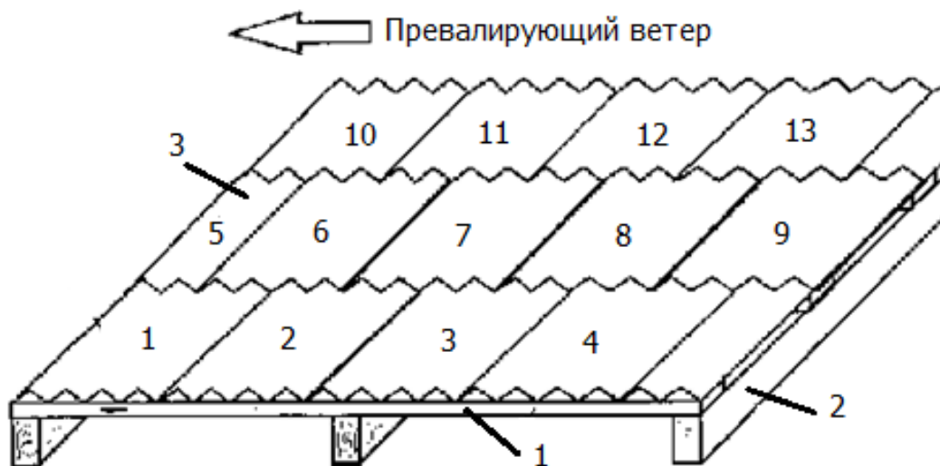
Рисунок 18 - Последовательность укладки ондулина
