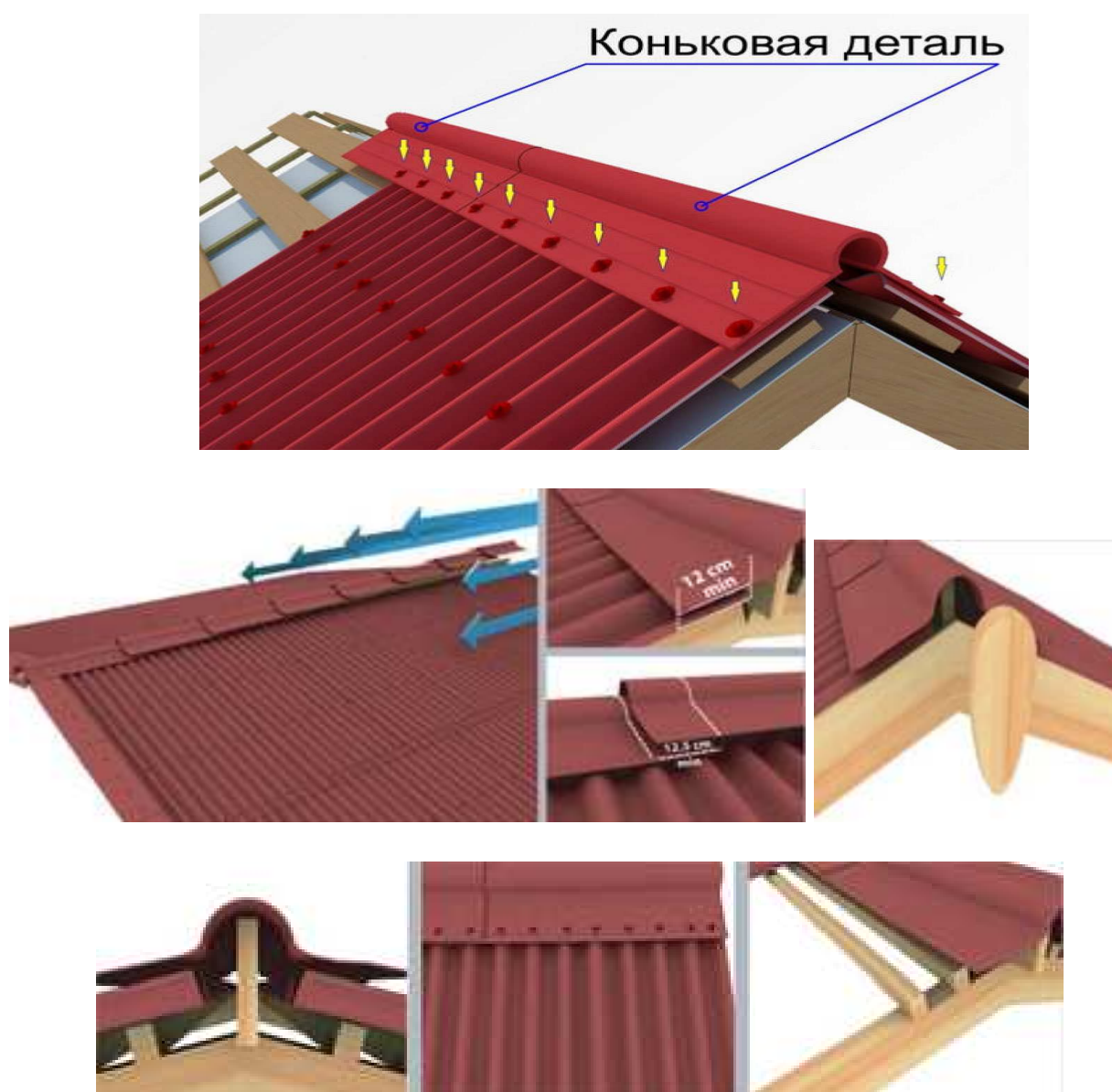
Рисунок 23- Установка коньковой планки
