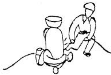
Рис 7 Оператор-пескоструйщик (ОП1) подготавливает пескоструйный аппарат к работе, подключает его к компрессору.
