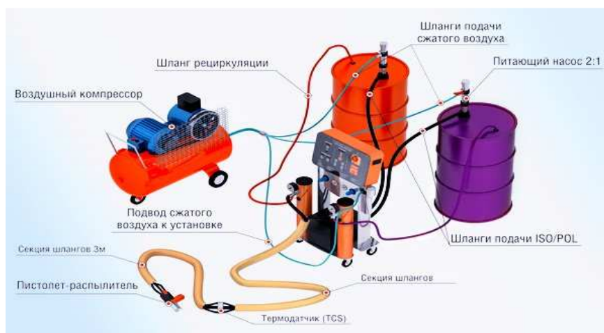
Рисунок 7 - Подключение оборудование "GAMA"
