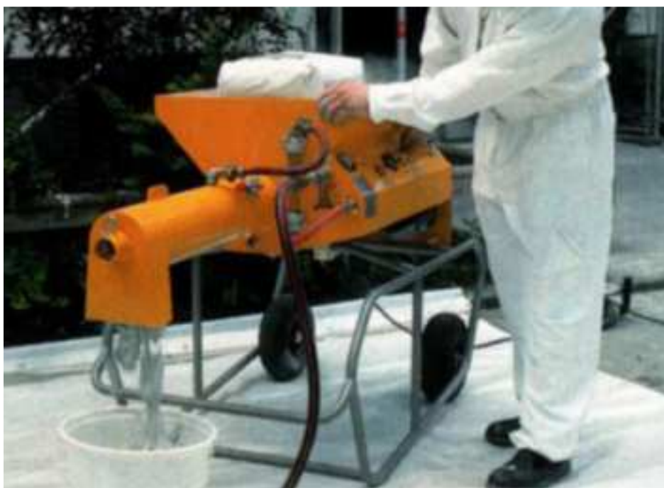
Рисунок 5 - Приготовление составов растворосмесителем
