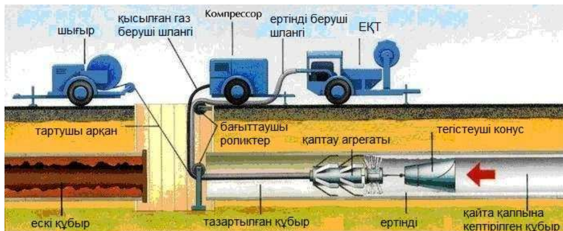
3-сурет – Цементті-құмды жабындыны қапталған агрегатпен бір уақытта тегістей отырып, құбырдың ішкі бетіне жабу үдерісі
