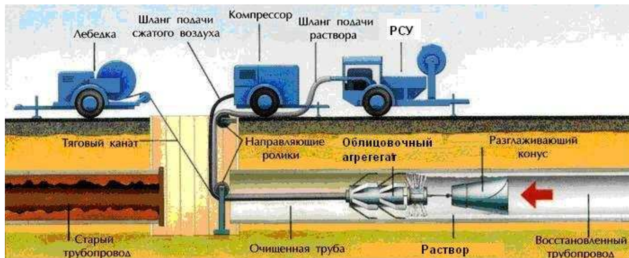
Рисунок 3 – Процесс нанесения цементно-песчаного покрытия на внутреннюю поверхность трубопровода облицовочным агрегатом с одновременным разглаживанием
