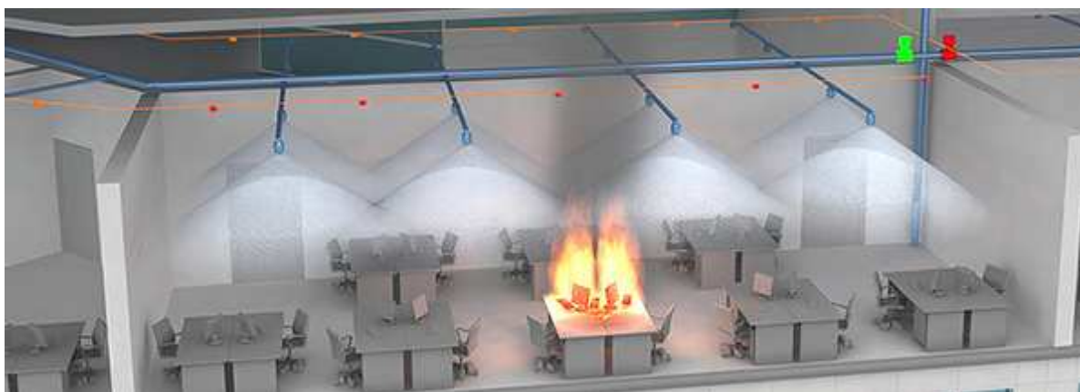
Рисунок 6 - Срабатывание автоматических установок порошкового пожаротушения
