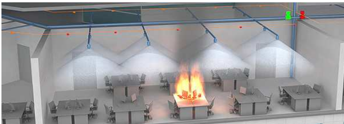
6-сурет - Ұнтақты өрт сөндірудің автоматты қондырғысының іске қосылуы
