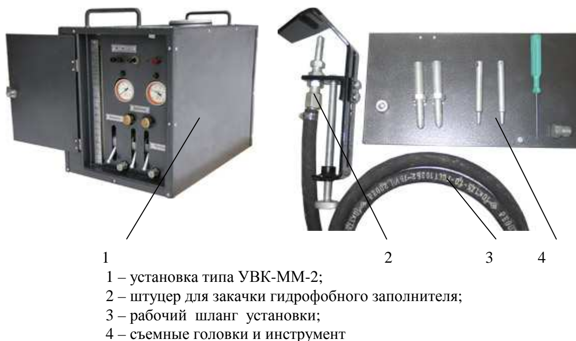
Рисунок 1 – Общий вид установки восстановления кабелей связи типа УВК-ММ-2
